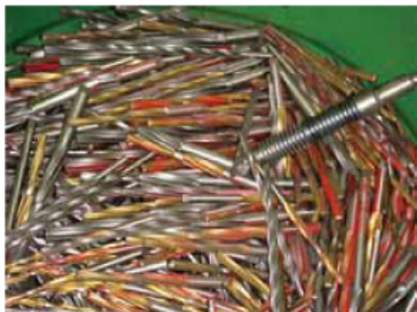
容器に分別された特殊銅クズをチェックする作業員。長年の「目利き」が光る(右)いわゆる「ハイス系」クズ。新品に思えるほどの「ドリル刃」に見えるがあくまでも「原料」だ(左)
